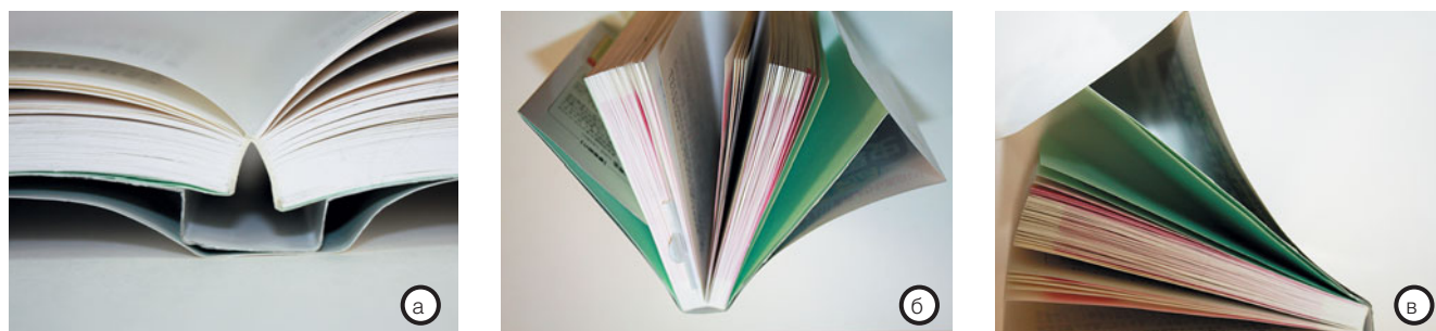
Рис. 1. Виды обложек: а — брошюра Otabind с суперобложкой; б и в — брошюра с суперобложкой и фальш-форзацем
