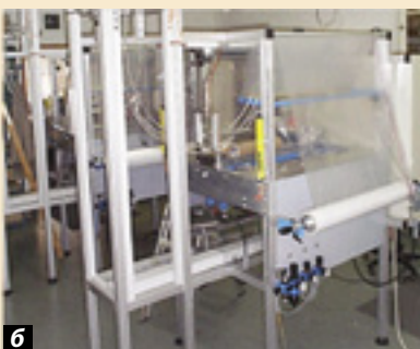
Дополнительные опции: а — устройство для счета и подборки стаканчиков; б — машина для упаковки в пленочный рукав
