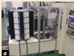
Дополнительные опции: а — карусельная буферная система для предварительной загрузки высеченных заготовок; б — устройство для высечки заготовок; в — устройство для высечки заготовок с опциональной двойной рулонной зарядкой
