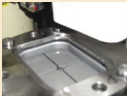
Две расширяющиеся станции обеспечивают плотное запечатывание по всей линии дна
