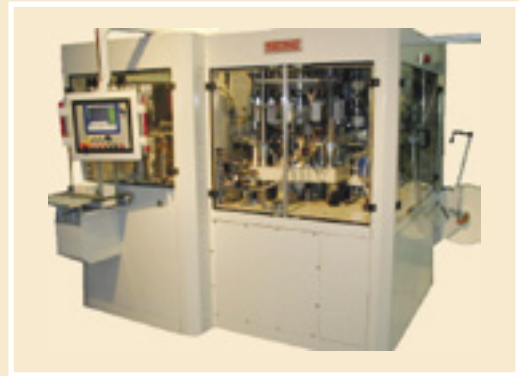
BMP 200 Universal с опциональной станцией сплющивания верхнего ободка подходит для изготовления питьевых стаканчиков, стаканчиков для мороженого и всех видов упаковочных контейнеров конусной формы. Максимальный размер стаканчика — до 1300 мл. Рабочая скорость — до 200 стаканчиков/мин; при установке некоторых опций скорость снижается до 170 стаканчиков/мин. Имеются опции для работы в линию, такие как аппликатор герметизирующей ленты на боковой шов, аппликатор ручек, станции для выдавливания канавки или сплющивания верхнего ободка. Можно изготавливать контейнеры круглой и некруглой формы
