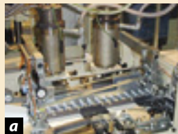
Слева направо: а — три станции нагрева бокового шва, б — плотное оборачивание; в — запечатывание всего бокового шва
