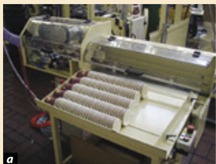
Дополнительные опции: а — устройство для счета и подборки стаканчиков; б — машина для упаковки в пленочный рукав
