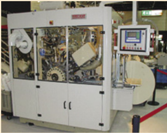
BMP 100 Compact: возможность изготовления только круглых стаканчиков и чашечек для мороженого на одну порцию. Скорость — до 180 стаканчиков/мин
