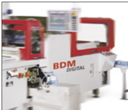
На машине BDM Digital изготавливают твердый переплет для фотобук
