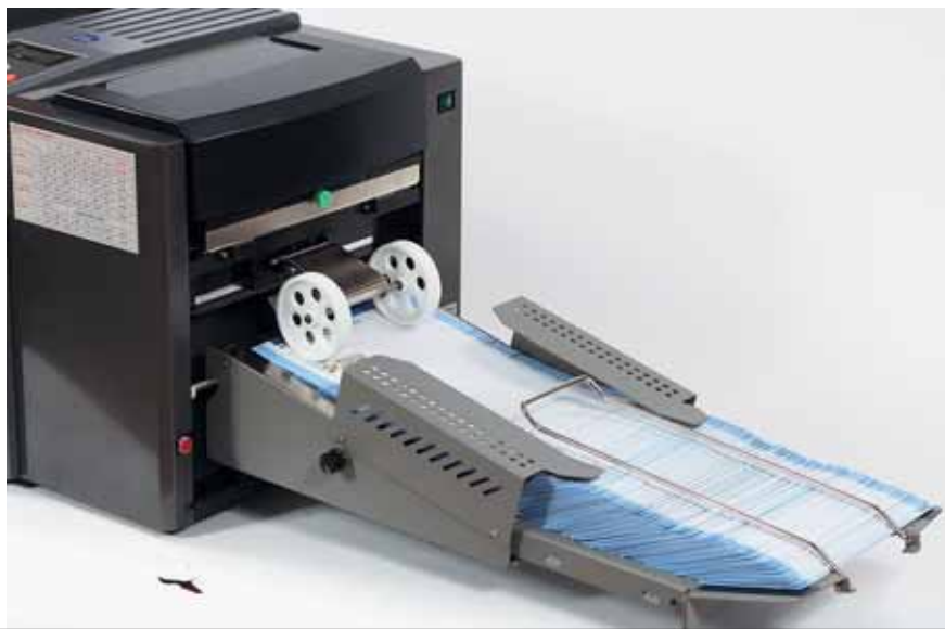
Готовые к отправке БПО выходят из настольного фальцовщика Postmate 6 HD
