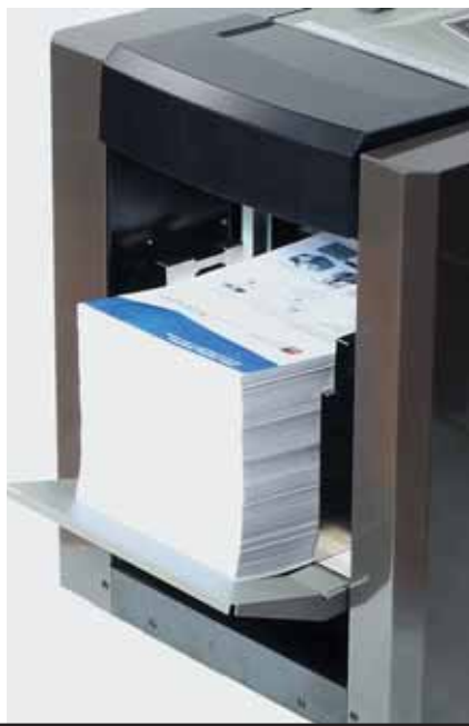
Система самонаклада фальцовщика Postmate 6 HD с отпечатанными на принтере письмами
