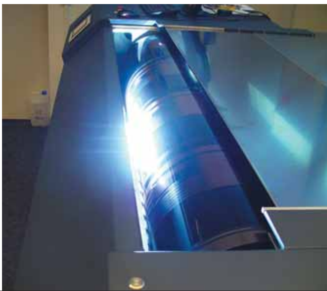
Процесс основного УФ-экспонирования в Esko CDI
