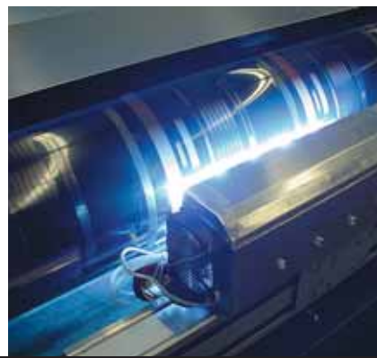
Встроенная в CtFP EskoArtwork CDI система основного УФ-экспонирования
