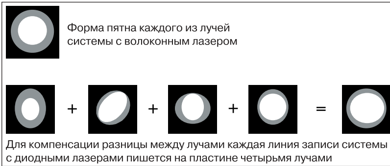
Рис. 3. Формы пятен лучей системы с волоконным лазером и системы с диодными лазерами
