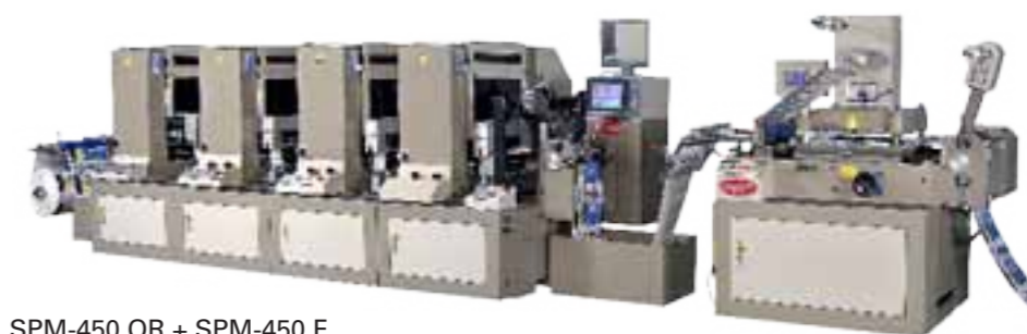
SPM-450 OR + SPM-450 F При работе этих машин в линию скорость до 12000 об/час (отт/час)
